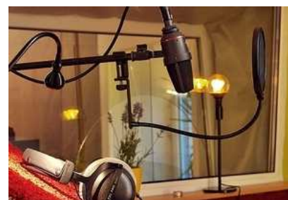
Mikrofonstativ mit Mikrofon und Windschutz. Der Kopfhörer darf nicht darüber gehängt werden!
